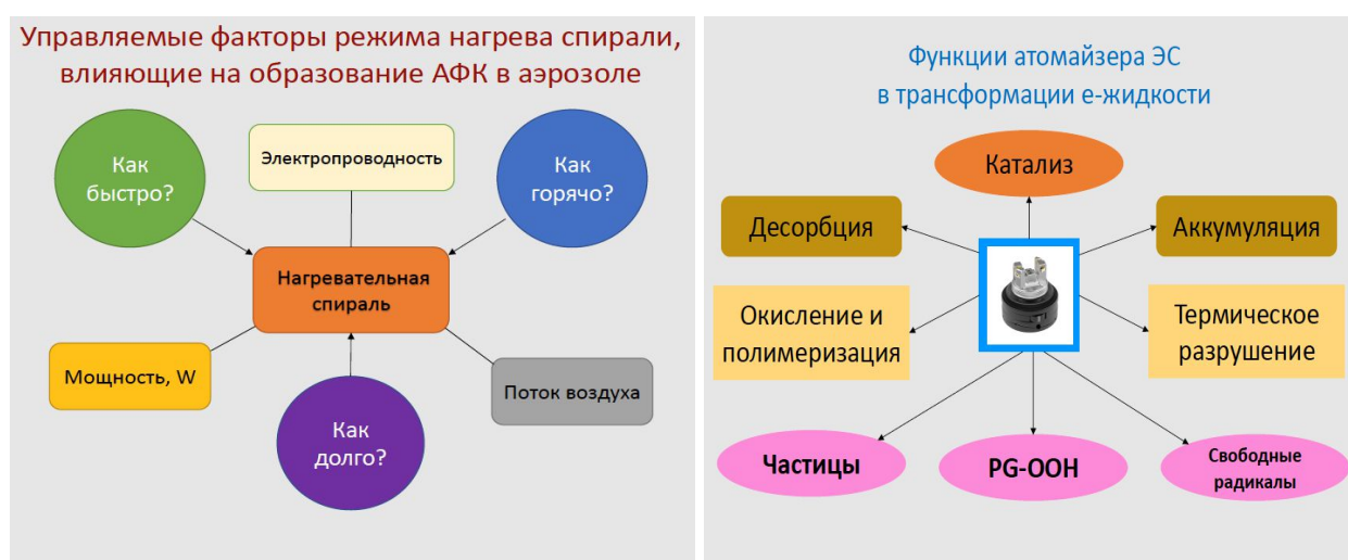
Рис. 16. Управляемые факторы образования АФК при использовании ЭС, связанные с конструктивными элементами, предназначенными для испарения, диспергирования и охлаждения аэрозоля.
