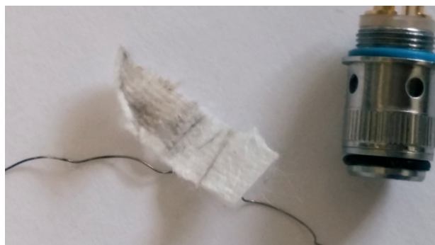
Рис. 7. Следы коррозии металла (оксид никеля) у нагревательной спирали (темно бурая пыль) на поверхности впитывающей ткани испарителя после недели активного использования ЭС второго поколения
